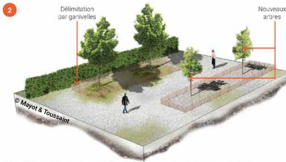
Etape 1: Plantation d'arbres et délimitation de zones de développement végétal
